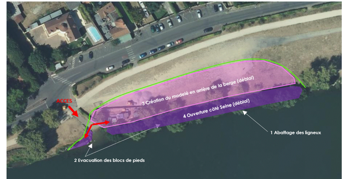
Figure 22 : Plan de phasage des travaux (Biotec, 2022)
