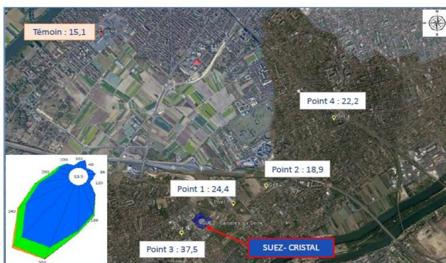
Figure 15 : Cartographie des teneurs totales en métaux observées (en µg/m<sup>2</sup>/j)
