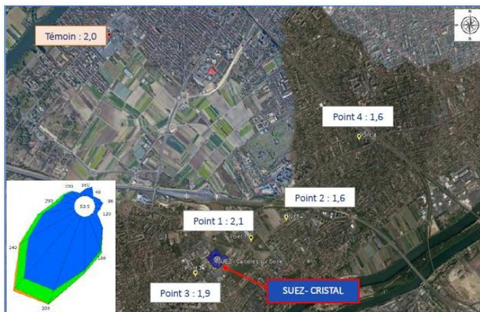
Figure 9 : Cartographie des teneurs en dioxines et furanes chlorés (en pg I-TEQ 01522002/m<sup>2</sup>/j)
