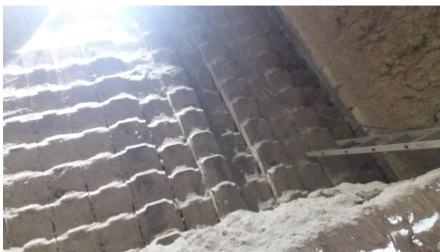
5.2.1.4 – Grille 2 : Remplacement de barreaux usés ou manquants.
